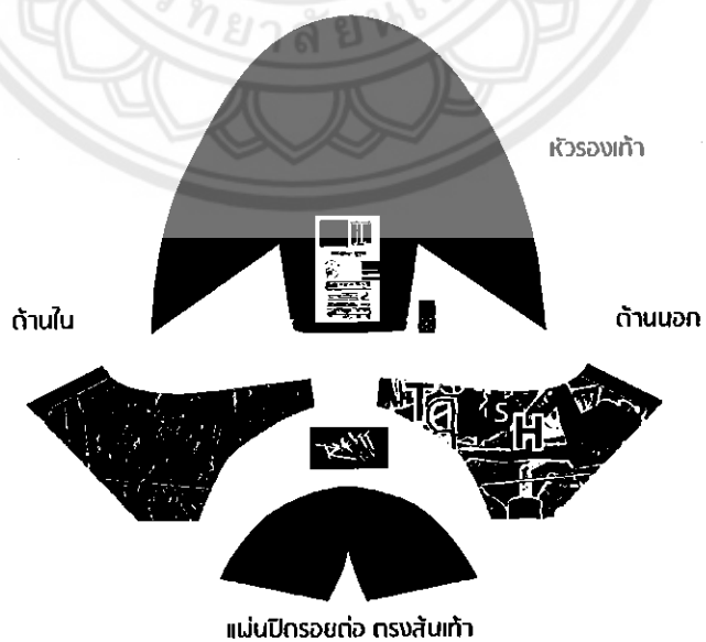
ภาพที่ 4.12.2 ภาพแสดงตัวอย่างแบบร่าง Pattern รองเท้าแบบสวม ช้างขวา
