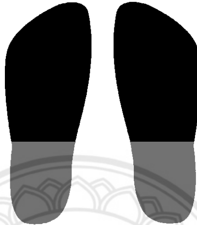
ภาพที่ 4.13 ภาพแสดงตัวอย่างแบบร่าง Pattern ซับในพื้นรองเท้า
