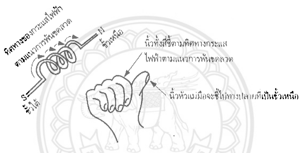
ภาพที่ 2.2 ภาพแสดงการใช้มือขวาหาขั้วเหนือและขั้วใต้ของแม่เหล็กไฟฟ้า
