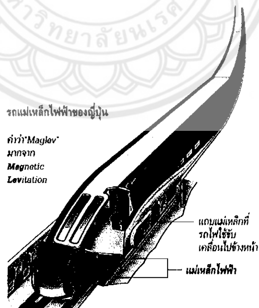
ภาพที่ 2.6 ภาพแสดงลักษณะการใช้แม่เหล็กไฟฟ้ากับรถไฟ
