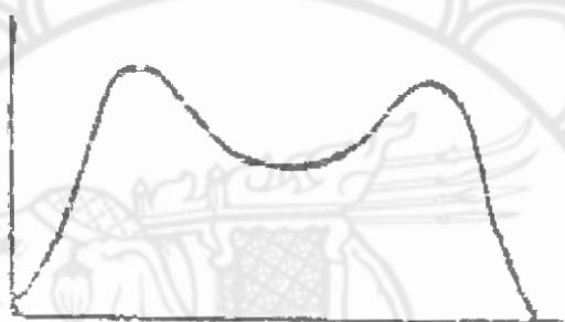
รูปที่ 2.14 แสดงการกระจายของละอองสารจากหัวฉีดรูปกรวย ( ที่มา : คำรง เวชกิจ และคณะ , 2536 )
