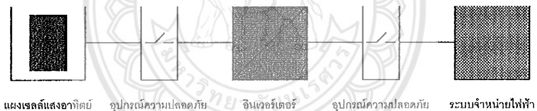
รูปที่ 24 ลักษณะของระบบผลิตไฟฟ้าด้วยเซลล์แสงอาทิตย์ต่อเข้าระบบจำหน่ายไฟฟ้า
