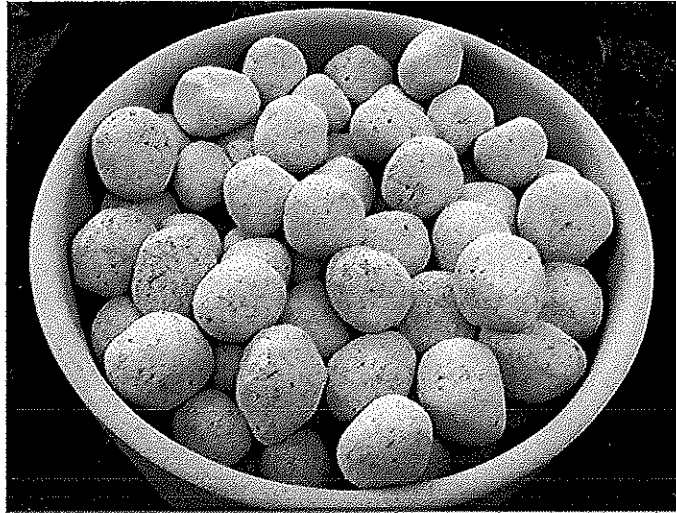
รูปที่ 3.4 แคลเซียมซัลโฟลูมิเนตที่ผ่านการเผาที่อุณหภูมิ 1,250 องศาเซลเซียส
