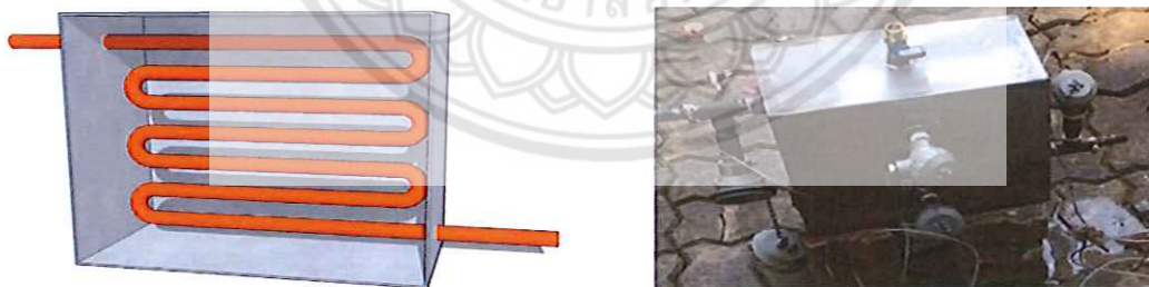
รูปที่ 3 แสดงชุดอุ่นน้ำร้อนจากพาราฟิน (PPH)
