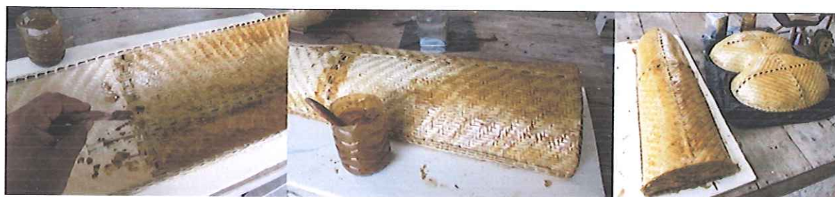
ภาพ 39 ทาส่วนผสมน้ำมันยางและชั้นเคลือบผิวชั้นในและนอกของรูปทรง
