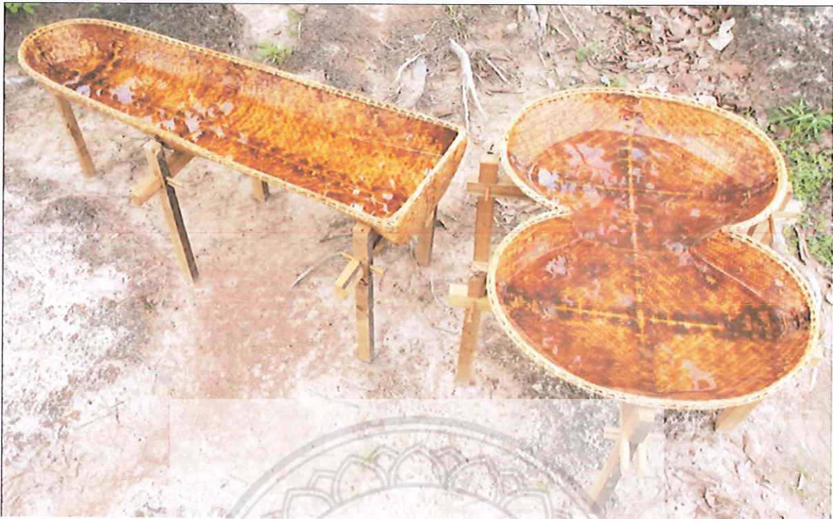
ภาพ 47 ใส่ของเหลวทดสอบการรั่วซึมของรูปทรง 2
