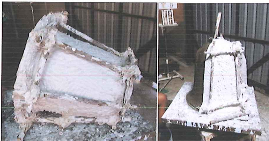
ภาพ 59 การทำพิมพ์ปูนปลาสเตอร์และถอดพิมพ์
