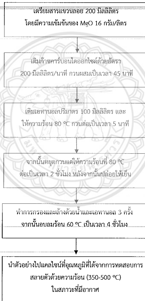
รูปที่ 2.21 แผนผังการปรับปรุงพื้นผิวของ MgO โดยวิธีการรวมตัวเป็นโครงสร้างแบบลำดับขั้น
