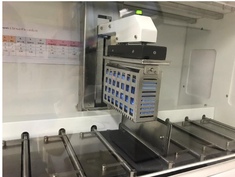
ภาพ 34 กระบวนการดึงน้ำออกจากเซลล์ด้วยเครื่องเตรียมชิ้นเนื้ออัตโนมัติ
