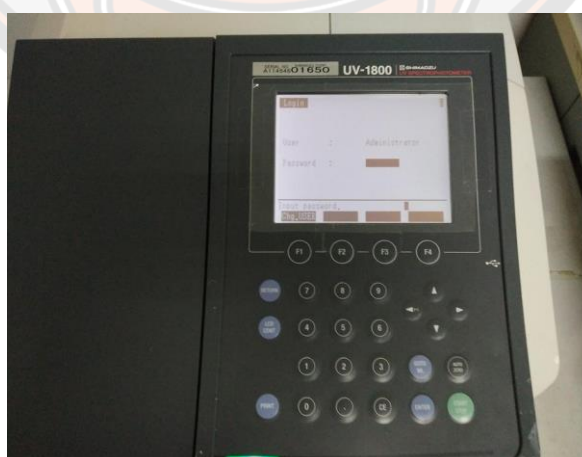
ภาพ 32 เครื่อง spectrophotometer ยี่ห้อ Shimadzu รุ่น UV-1800
