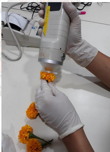
ภาพ 31 การวัดค่าสีดอกดาวเรืองด้วยเครื่อง Chroma Meter CR-400
