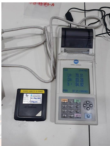
ภาพ 30 เครื่อง Chroma Meter CR-400 ยี่ห้อ Konica Minolta
