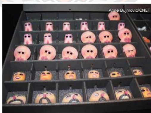
ภาพ 73 แสดงใบหน้าตัวละครที่ผลิตด้วยเครื่องพิมพ์ผงสี 3 มิติ
