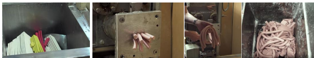
ภาพ 65 แสดงเครื่องนวดดินน้ำมันของบริษัท Aardman Animation ใช้ผสมสีดินน้ำมัน
