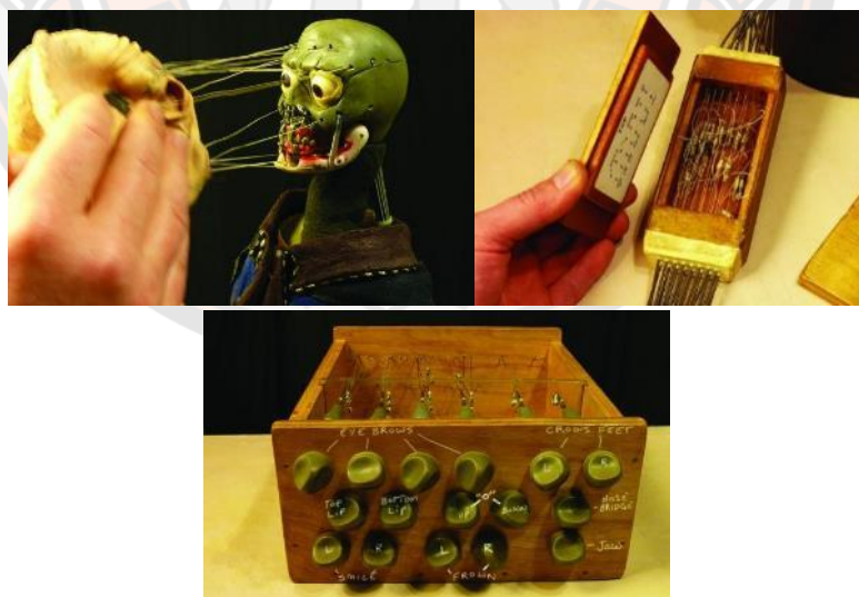
ภาพ 131 แสดง Face Armature ที่ควบคุมด้วยสายเคเบิลและกล่องควบคุม
