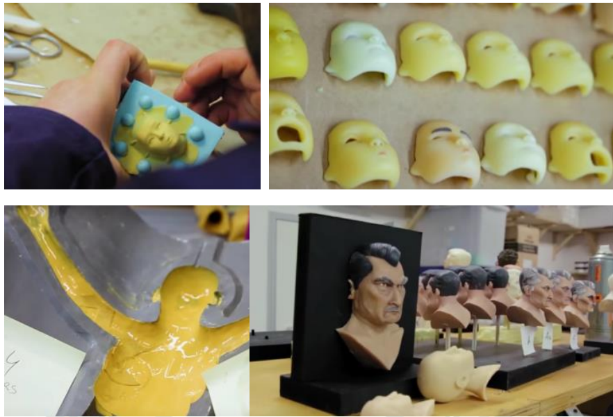
ภาพ 70 แสดงใบหน้าของตัวละครสามารถถอดเปลี่ยนได้ทำจากแม่พิมพ์ยางซิลิโคนและเรซิน ที่มา: ISLE OF DOGS | "Making of: Puppets" Featurette; https://bit.ly/2rODRg2 , 2018
