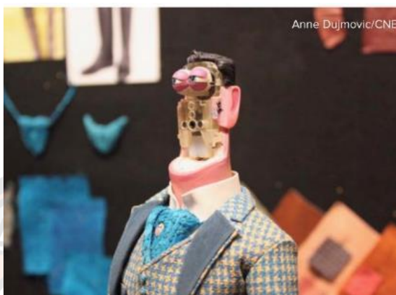
ภาพ 74 แสดงใบหน้าตัวละครที่ผลิตด้วยเครื่องพิมพ์ผงสี 3 มิติ
