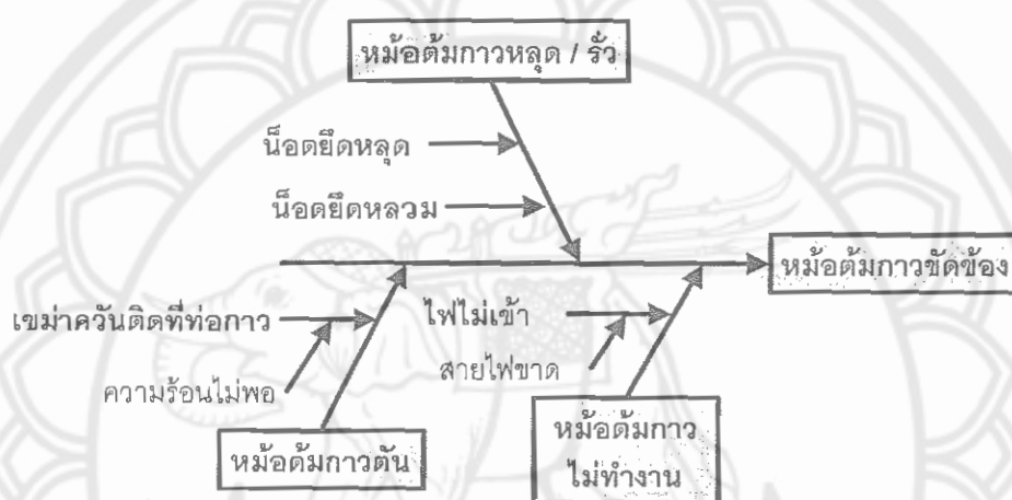
รูปที่ 4.32 ผังก้างปลาวิเคราะห์ปัญหาของหม้อต้มกาวขีดข้อง
