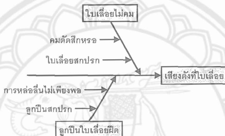
รูปที่ 4.26 ผังก้างปลาวิเคราะห์ปัญหาเสียงดังที่ใบเลื่อย
