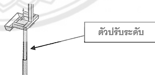
รูปที่ 4.13 ส่วนกลางของอุปกรณ์ช่วยยก FLY WHEEL
