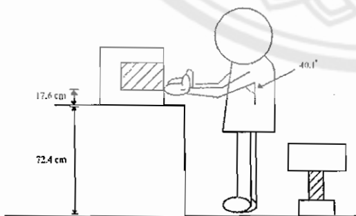
รูปที่ 4.19 แสดงลักษณะการติดตั้ง Applicator กับเครื่องของจุดงาน Y.C.M.
