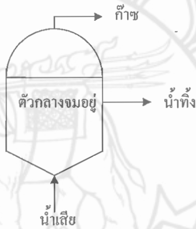
รูปที่ 2.23 ถังกรองไร้อากาศ
