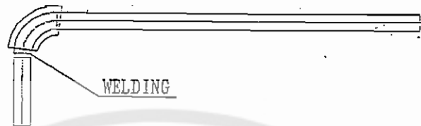
รูปที่ 3.25 รูปแสดงการเชื่อมท่อด้านในอีกด้านเข้ากับข้ออ (elbow) :[3]
