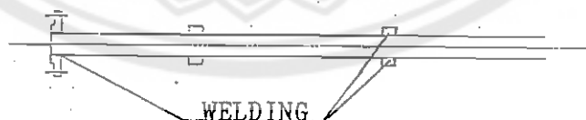
รูปที่ 3.15 รูปแสดงการเชื่อมหน้าแปลน (flange) และ (Spacer) เข้ากับท่อด้านใน: [3]
