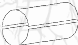
รูปที่ 3.32 รูปแสดงวิธีการประกอบท่อผ่า (split) แบบสามทาง(tee) เข้ากับท่อด้านใน:[3]
