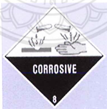
ภาพ 5.14 สัญลักษณ์แสดงสารกัดกร่อน ที่มา : กรมควบคุมมลพิษ (2545)
