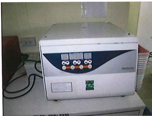
ภาพ 3.12 เครื่องปั่นเหวี่ยงสารให้ตกตะกอน
