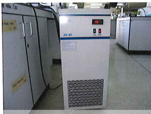
ภาพ 3.5 ถังน้ำหล่อเย็น
