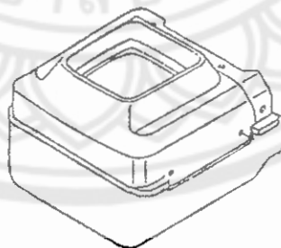
รูปที่ 2.12 หม้อน้ำแบบอ่างน้ำ (ที่มา คู่มือการอบรมเครื่องยนต์คีเซลด,กูโบตา)
