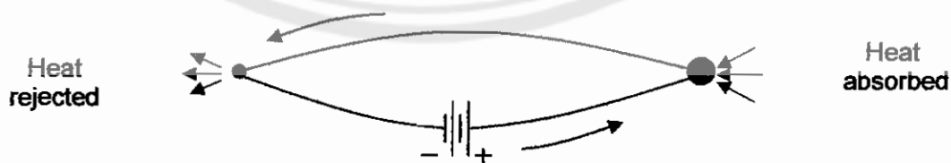
รูปที่ 2.4 เมื่อมีกระแสไฟฟ้าไหลผ่านวัสดุ 2 ชนิดที่เชื่อมต่อกันที่รอยต่อด้านหนึ่งจะเย็นตัวลง
