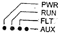
รูปที่ 2.5 หลอด LED แสดงสถานะการทำงานของ PLC (T1-40)
