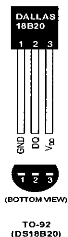
รูปที่ 2.5 แสดงขาและตัวถัง TO-92 ของไอซี DS18B20
