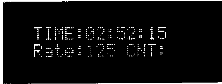
รูปที่ 3.12 ข้อความบนจอแสดงผลในขณะที่อุปกรณ์นับหยดน้ำเกลือ
