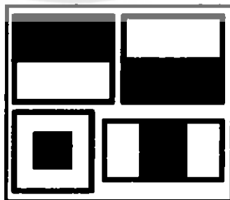
รูปที่ 2.13 แสดงตัวอย่างลักษณะเด่นของ Haar ที่ถูกใช้ใน OpenCV
