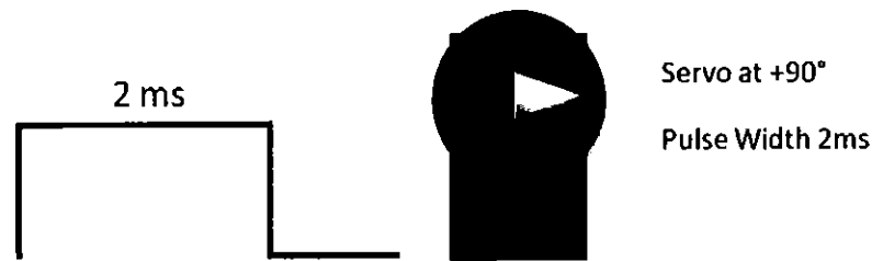
รูปที่ 3.5 แสดงสัญญาณพัลส์ที่ 2 มิลลิวินาที ตำแหน่งของเซอร์โวมอเตอร์อยู่ที่ +90 องศา
