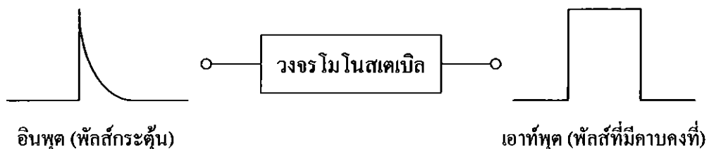
รูปที่ 2.5 หลักการทำงานพื้นฐานของวงจร โมโนสเตเบิลมัลติไวเบรเตอร์
