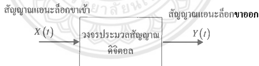
รูปที่ 2.14 โครงสร้างระบบประมวลผลสัญญาณแอนะล็อก
