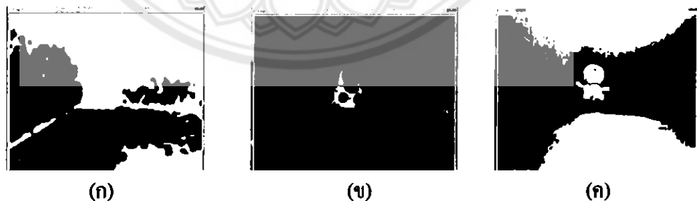
รูปที่ 3.56 การทำกรอง Noises ด้วย Median filter ด้วย Mask 3 x 3
