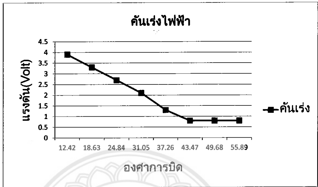
รูปที่ 4.18 กราฟแสดงความสัมพันธ์ระหว่างองศาการบิดคั่นแรงกับค่าแรงดันไฟฟ้าของคั่นแรง
