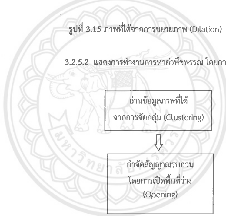
รูปที่ 3.16 ไตอะแกรมแสดงการทำงานของการทำงานของการเปิดพื้นที่ (Opening)
