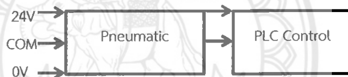
รูปที่ 4.17 แสดงแผนภาพขั้นตอนการทำงานการเชื่อมต่อนิวแมติกกับระบบตรวจสอบและคัดแยกสินค้าอัตโนมัติ
