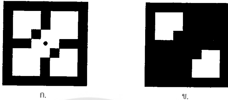
รูปที่ 2.30 แสดงการเทสีแบบ 4-Connected
