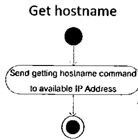
รูปที่ 3.29 Activity Diagram ของการร้องขอชื่อเครื่องลูกข่าย
