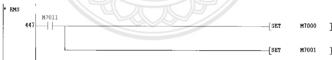
รูปที่ 3.78 ส่วนปุ่มหยุดฉุกเฉิน (Emergency Stop)
