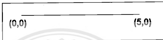
รูปที่ 2.19 ตัวอย่างการวาดเส้นตรงด้วยการพิมพ์คำสั่งทาง Command Line
