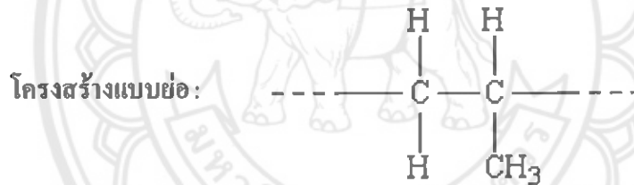
รูปที่ 2.10 แสดงโครงสร้างแบบย่อของพอลิพรอพิลีน [4]
