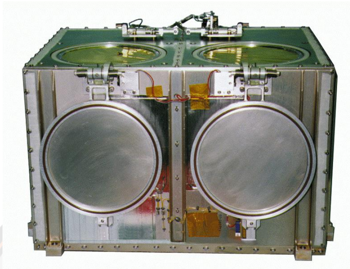
ภาพที่ 13 แสดงเครื่องมือตรวจวัด SIS บนยานอวกาศ ACE
