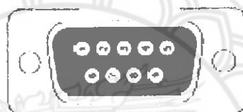
รูปที่ 2.20 DB9 ตัวผู้ เมื่อมองจากด้านหลัง
