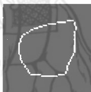
รูปที่ 3.13 ตัวอย่างของรูปภาพที่ผ่านการหาขอบโดยใช้แคนนี่ (Canny Edge Detection)
