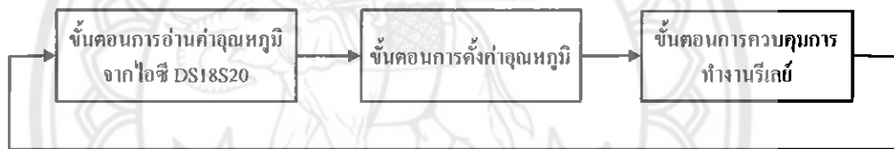
รูปที่ 3.4 แผนภาพการทำงานของเครื่องควบคุมอุณหภูมิ
