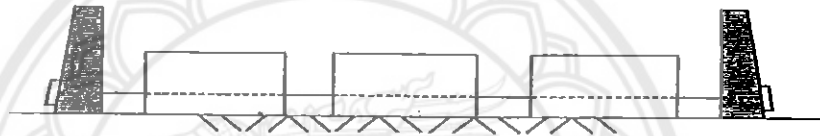
รูปแสดง การหล่อชิ้นงานหลายๆชิ้นพร้อมกัน โดยการอัดแรงชนิดค้ำเหล็กก่อน
