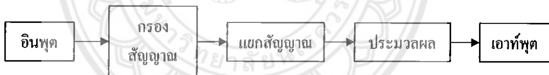
รูปที่ 3.3 แผนภาพกรอบแสดงขั้นตอนการทำงานของส่วนประมวลผล
