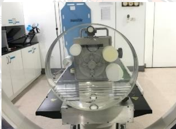
ภาพ 19 การจัดอุปกรณ์ในการสแกน TOS Phantom
