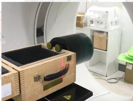
ภาพ 17 การจัดอุปกรณ์ในการสแกน Catphan Phantom 600
