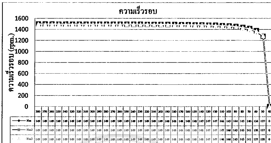
รูปที่ 4.12 เปรียบเทียบความเร็วรอบจากการลดแรงดันไฟฟ้าที่สภาวะ โหลด 0% รวมทั้ง 3 ครั้ง
