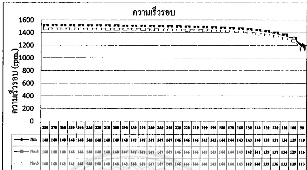
รูปที่ 4.18 เปรียบเทียบความเร็วรอบจากการลดแรงดันไฟฟ้าที่สภาวะ โหลด 10% รวมทั้ง 3 ครั้ง
