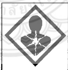
รูปที่ 2.19 สัญลักษณ์วัตถุเป็นอันตรายต่อสุขภาพ
