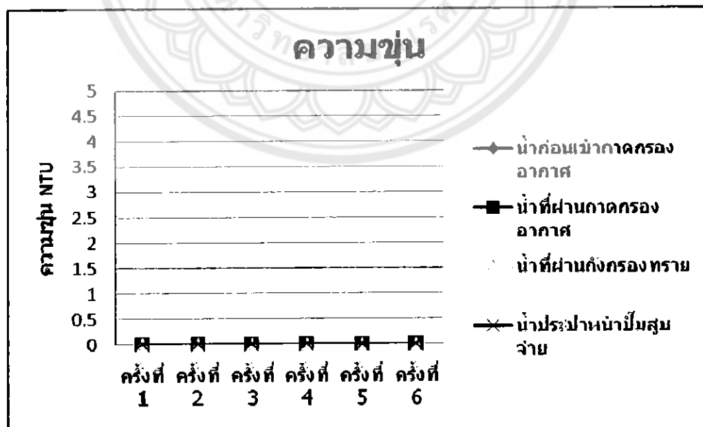
รูปที่ 4.13 กราฟแสดงค่าความขุ่นของน้ำที่ผ่านถังตกตะกอนและน้ำประปา
