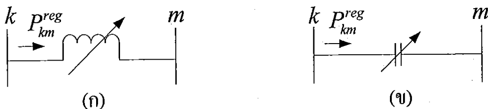
รูปที่ 2.16 วงจรเทียบเท่าของ Thyristor-Controlled Series Compensator (ก) การดำเนินการในย่านอินดักทีฟ (Inductive Region) และ (ข) การดำเนินการในย่านคาปาซิทีฟ (Capacitive Region) [4].
