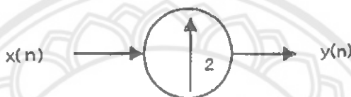
รูปที่ 2.6 แผนภาพการเพิ่มข้อมูลขึ้นเป็นสองเท่า [3]
