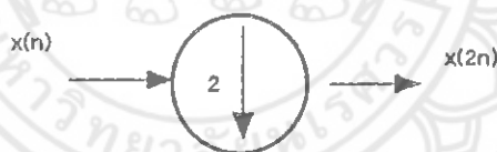
รูปที่ 2.4 แผนภาพการลดข้อมูลลงครึ่งหนึ่ง [3]
