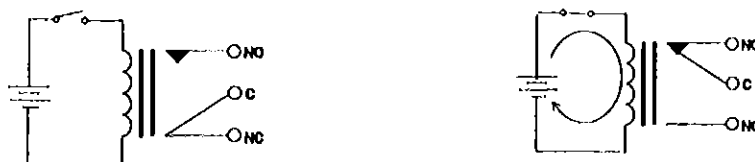
รูปที่ 2.20 เมื่อไม่ใส่กระแสไฟจะเป็นวงจรเปิด รูปที่ 2.21 เมื่อใส่กระแสไฟจะเป็นวงจรปิด
