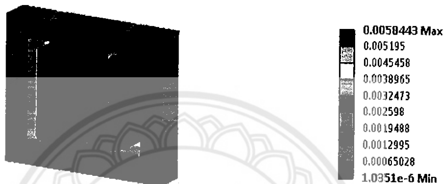
(a) การกระจายของเส้นแรงแม่เหล็ก (b) ค่าความหนาแน่นของเส้นแรงแม่เหล็ก
