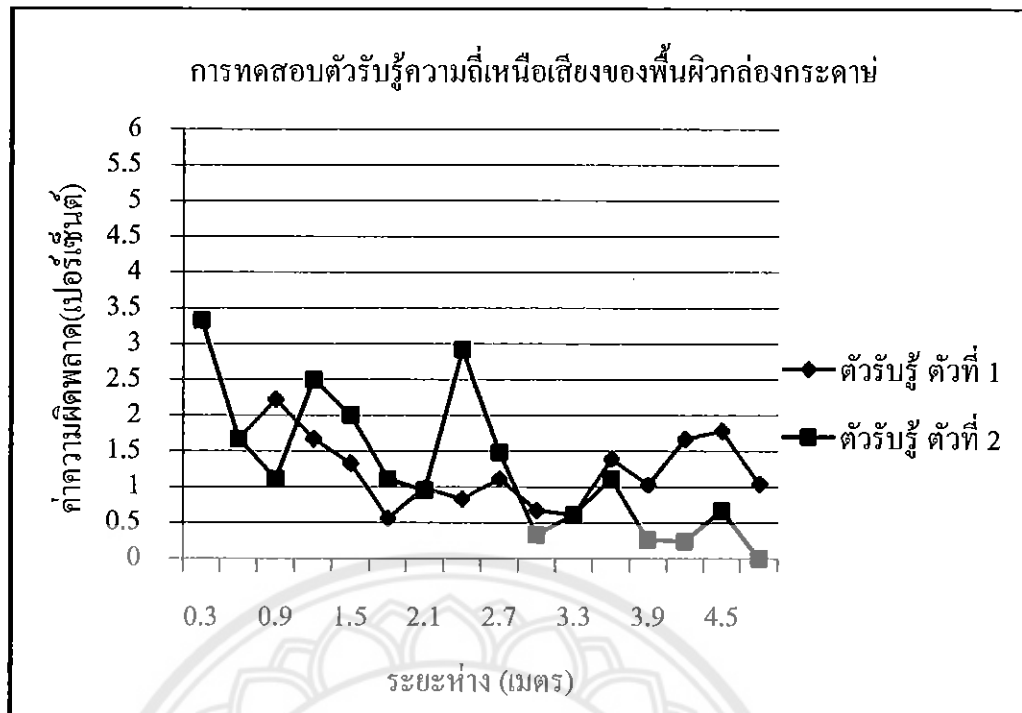
รูปที่ 4.6 เปอร์เซนต์ค่าความผิดพลาดเมื่อทดสอบกับพื้นผิวกล่องกระดาษ
